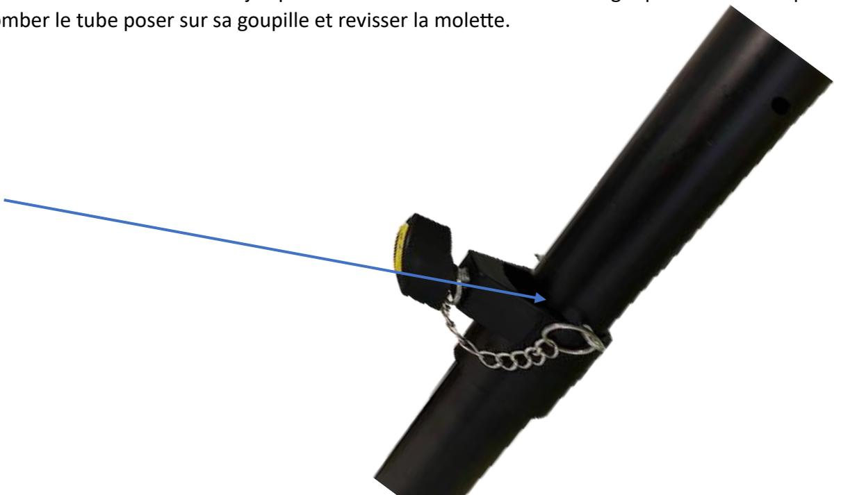
4. Dévisser la 3eme molette et y insérer le tube en laissant environ 2 orifices ou plus haut si vous souhaitez lever d'avantage, insérer la goupille et répéter l'opération ci-dessus. **Attention** à bien dévisser la molette comme sur la photo afin que le TUBE ne se bloque pas :
